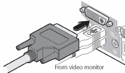
FIGURE 3-4. CONNECTING A VIDEO MONITOR TO THE USER CONSOLE
