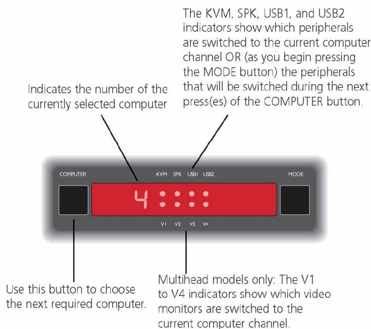
FIGURE 5-1. FRONT-PANEL BUTTONS
