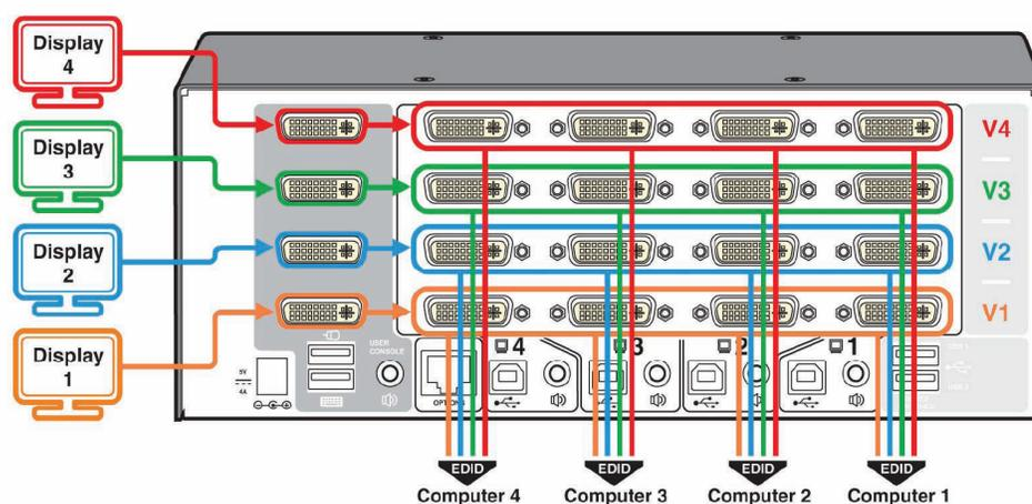
FIGURE 3-18. MULTISCREEN CONFIGURATION
