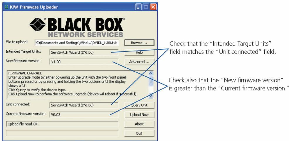
FIGURE 4-2. SELECTING THE UPGRADE FILE FROM THE KVM FIRMWARE UPLOADER WINDOW
