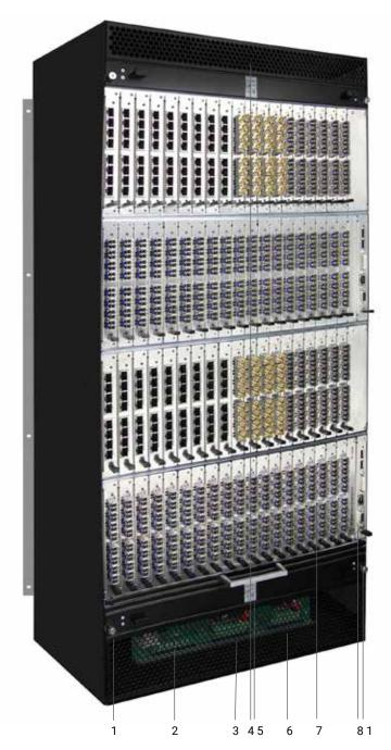
FIGURE 2-2. 576-PORT CHASSIS, FRONT VIEW
